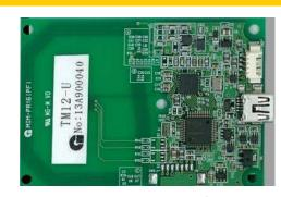
13.56MHz帯域のさまざまな RFIDタグやカードに対応した リーダライタモジュールです。 インジケータ用赤/緑の2色 LEDを搭載しています。
